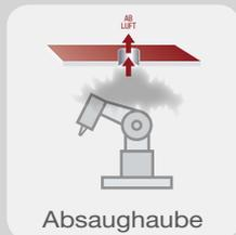
Absaughauben können fix oder mitfahrend direkt am Roboter montiert werden und garantieren eine hochgradige Erfassung.
