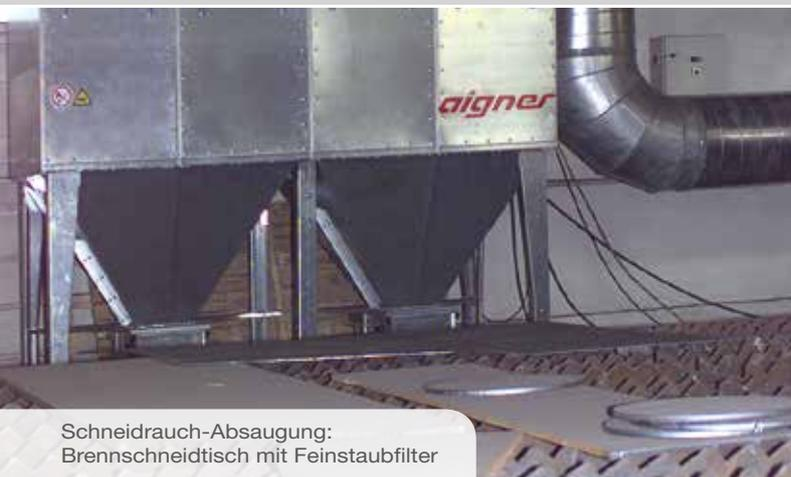
Schneidrauch-Absaugung: Brennschneidertisch mit Feinstaubfilter
