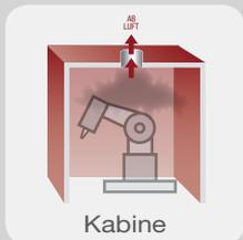
Roboteinhausungen garantieren bestmögliche Erfassung des Schweißrauches. Ein effektiver Lärm und Blendschutz!
