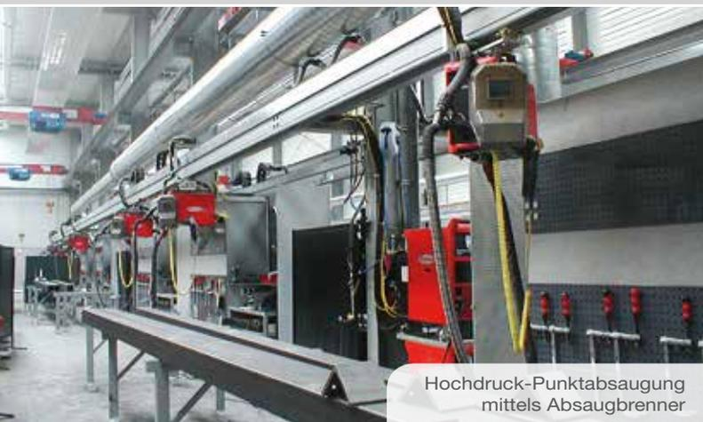
Hochdruck-Punktabsaugung mittels Absaugbrenner
