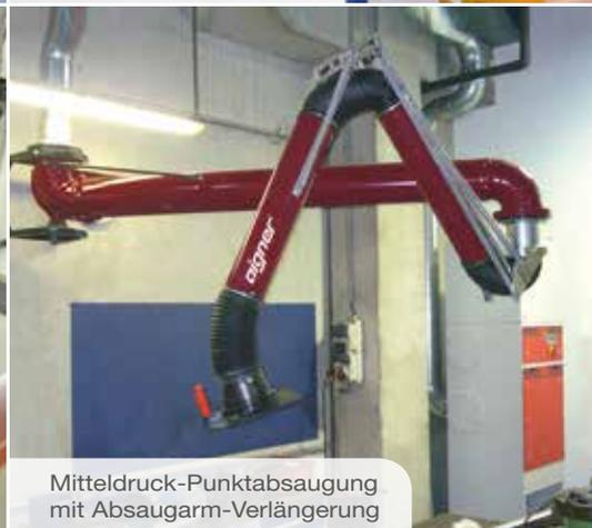
Mitteldruck-Punktabsaugung mit Absaugarm-Verlängerung
