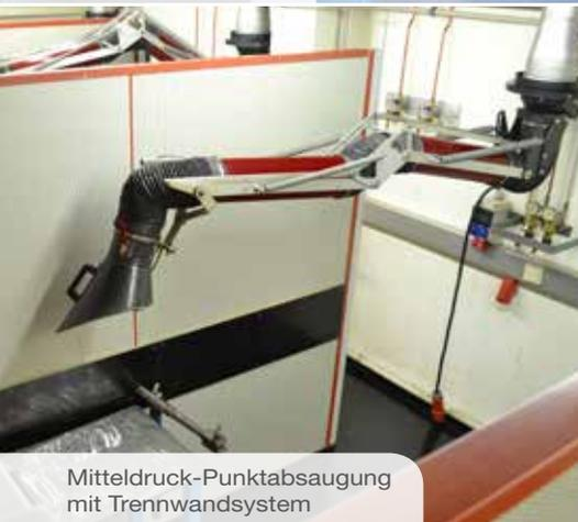
Mitteldruck-Punktabsaugung mit Trennwandsystem
