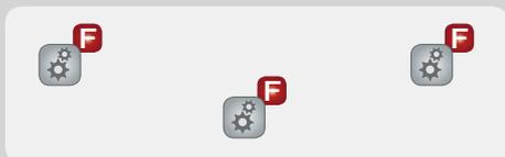
An jede Werkzeugmaschine wird individuell jeweils eine Absaug- und Filteranlage angeschlossen.
