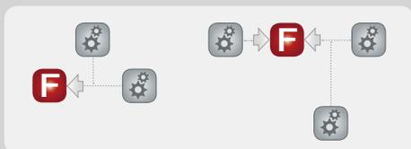
Hier werden Maschinen-Gruppen zusammengefasst und mit semi-zentralen Absaug- und Filteranlagen verbunden.
